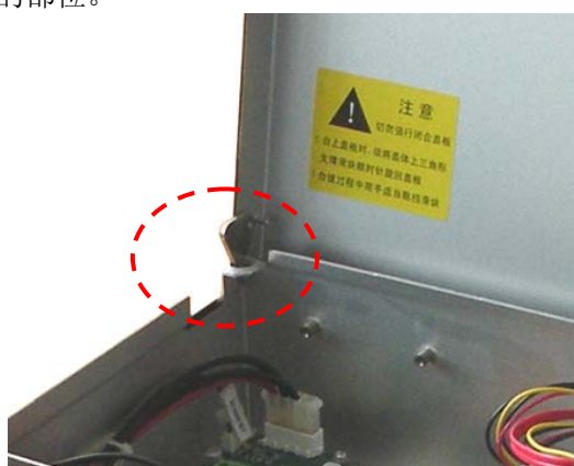
图 2-10. 机箱开盖示意图
